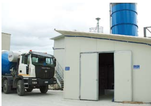
In alto da sinistra, locale additivi e compressori e gruppi di dosaggio additivi.
