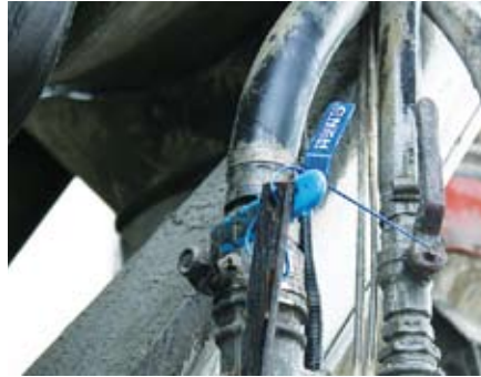
Il sigillo apposto alla leva di immissione dell'acqua in autobetoniera
